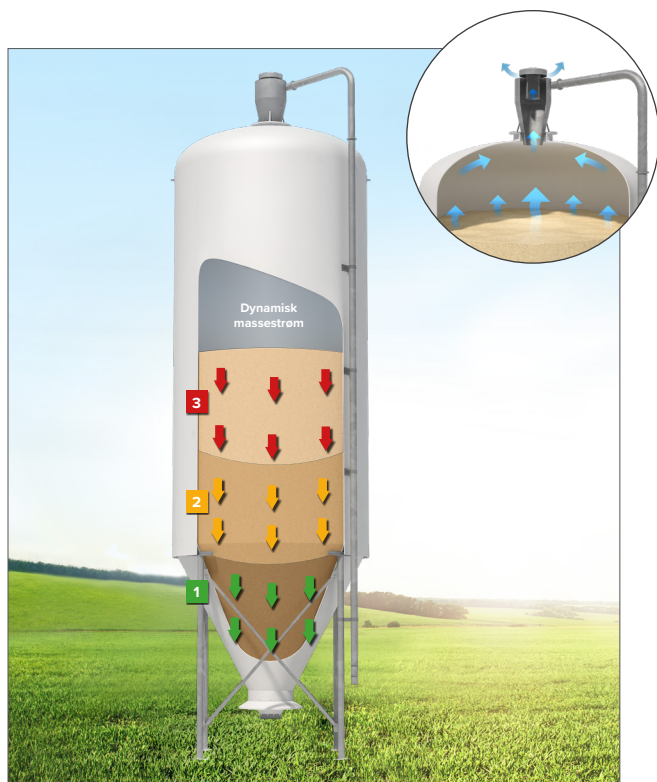
Et effektivt indblæsningssystem med cyklon og udluftning fordeler mediet så dette ikke pakker sig hårdt i siloen og minimerer kondens.
