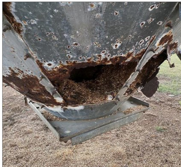
En glasfibersilo rustet ikke! Salt og ammonium i foderet i forbindelse med kondensvand giver kemisk tæring, men kompositmateriale er resistent herimod.
